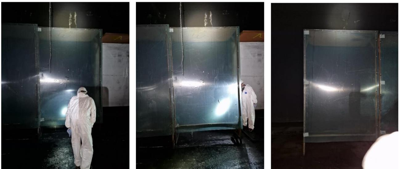
Abbildung 6: An den seitlichen Zielbrandlasten (benachbarter Bus) waren keine Beschädigungen festzustellen.
